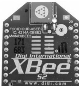
FIGURA 3. XBEE SERIE 2 PARA LA TRANSMISIÓN INALÁMBRICA DE DATOS
