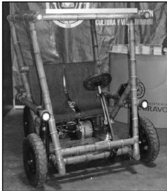
FIGURA 1. VEHÍCULO SOLAR-ELÉCTRICO RIZOMA 0.1 DISEÑADO Y CONSTRUIDO EN LA INSTITUCIÓN UNIVERSITARIA PASCUAL BRAVO
