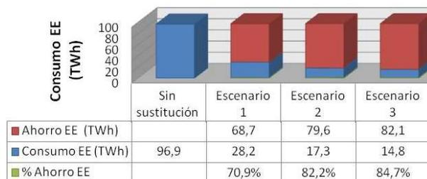
FIGURA 1. AHORRO POTENCIAL DE EE AL SUSTITUIR LÁMPARAS INCANDESCENTES POR CFL Y POR LED.
