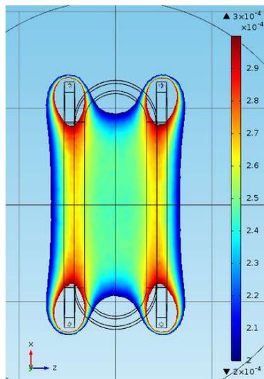
FIGURA 2. DENSIDAD DE FLUJO DE CAMPO MAGNÉTICO EN EL PLANO XZ DE LA CONFIGURACIÓN DE BOBINAS.
