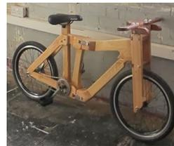
b. Bicicleta plegable de madera doble triángulo [18].
