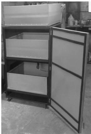
FIGURA 1. CÁMARA DE SECADO DE TRES BANDEJAS
