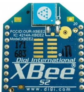
Figura 2. XBee serie 2 para la transmisión inalámbrica de datos
