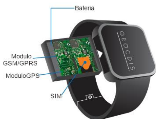
Figura 2. Diseño de componentes electrónicos y prototipo desarrollado.
