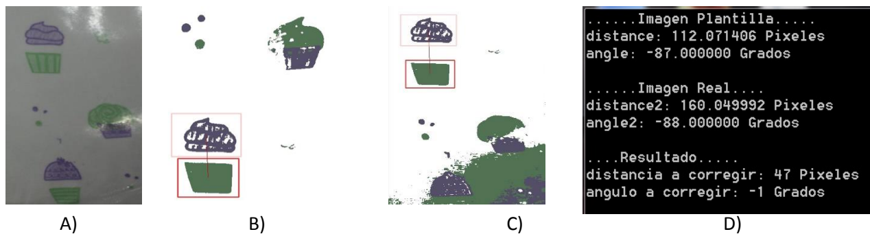
Fig. 6. A) Imagen real, B) Imagen plantilla individualizada, C) Imagen plantilla segmentada e individualizada, D) datos de imagen real y plantilla y, resultado de la comparación
