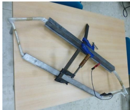
Figura 7. Simulación completa del entrehierro usando los perfiles metálicos y conectándolos entre sí por medio de un cable común
